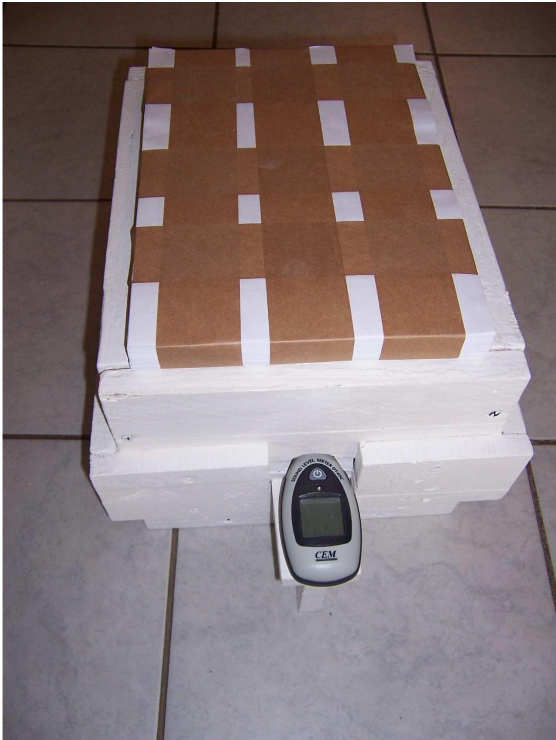
Pour chaque son testé, régler le volume pour que sans échantillon, la mesure se situe autour de 100dB, puis insérer les échantillons et faire les mesures.
